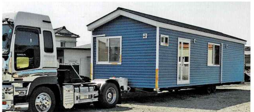
基準緩和認定を受け、かつ特殊車両通行許可の認定を受けたトレーラーハウス
