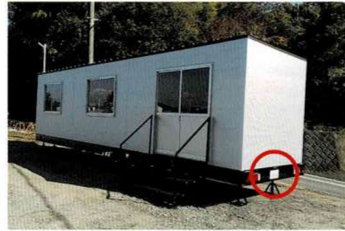
車検取得しナンバープレートを取り付けたトレーラーハウス
